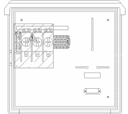
Diseñada para favorecer el efecto de convección natural con el fin de evitar condensaciones internas, ofreciendo a la vez una gran resistencia a las principales agresiones químicas y medio ambientales así como a la acción de los rayos U.V.
